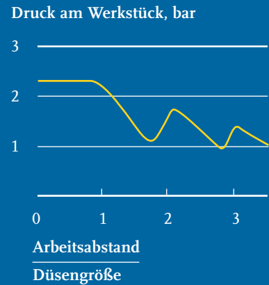
Bild 8: Einfluss von Düsengröße und Arbeitsabstand auf den effektiven Schneidgasdruck
